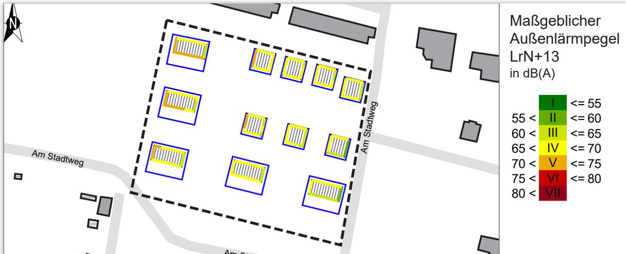
Abbildung 5-4 Lärmpegelbereiche und resultierende Schalldämm-Maße der Außenbauteile - 1.OG
