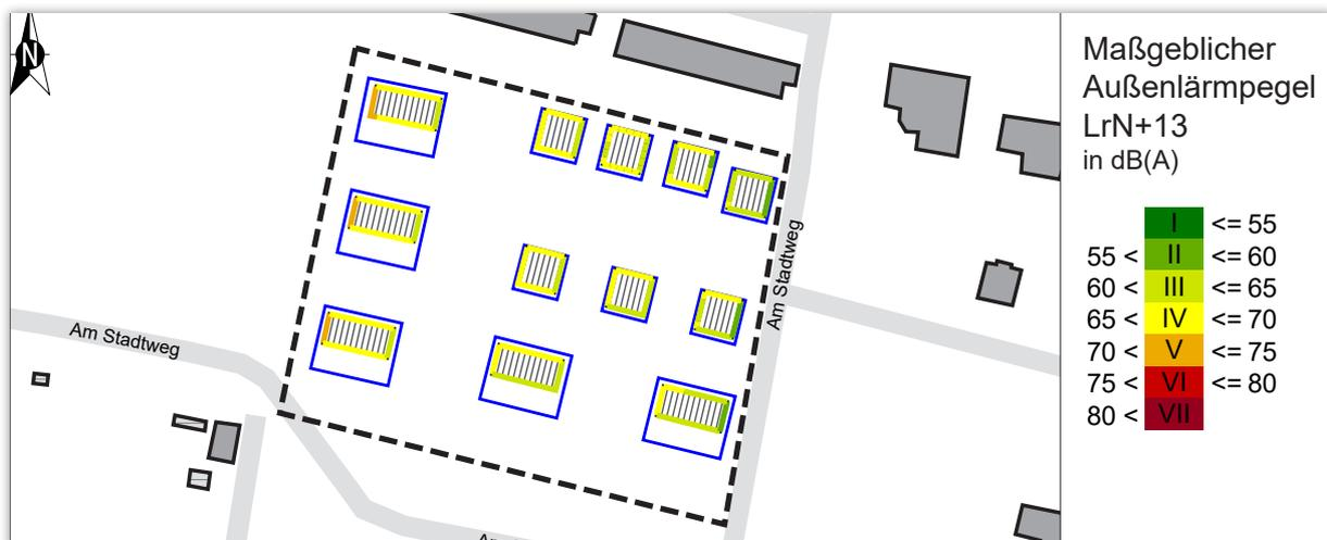
Abbildung 5-3 Lärmpegelbereiche und resultierende Schalldämm-Maße der Außenbauteile - EG
