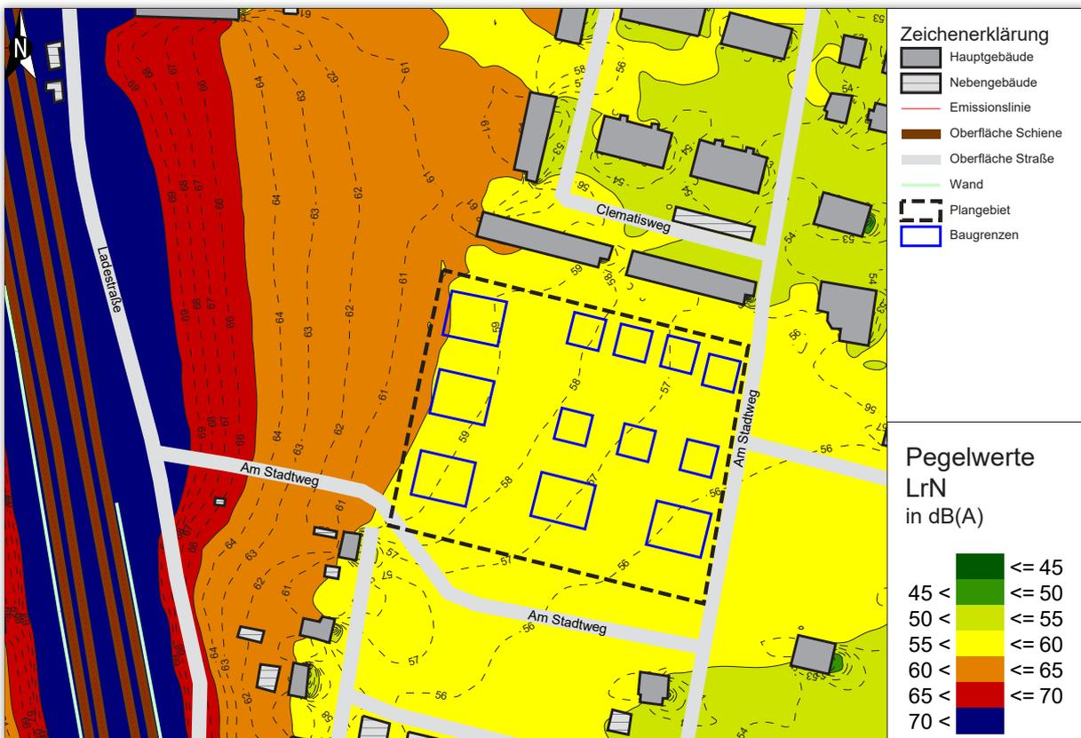
Abbildung 5-2 Beurteilungspegel in 5 m Höhe nach DIN 18005, nachts 22:00 - 6:00 Uhr
